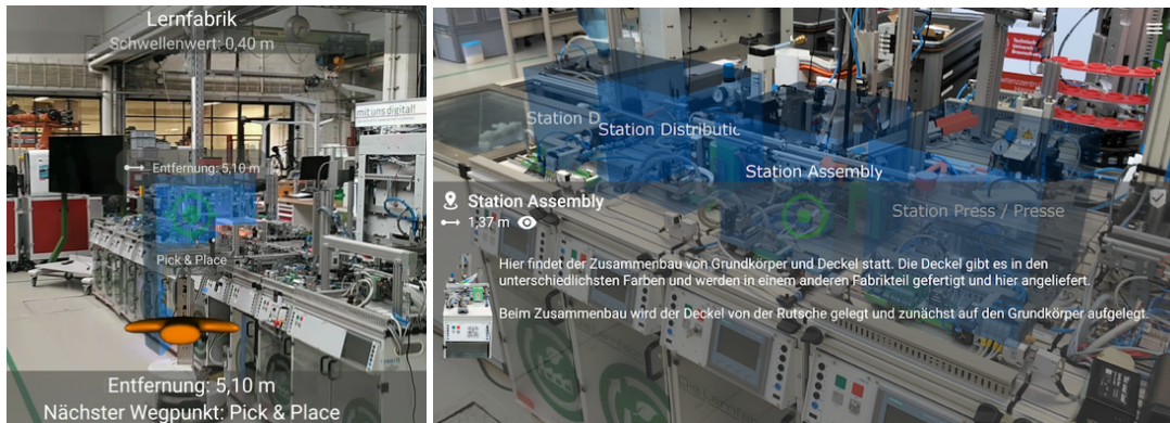
Abb. 2: Augmentierte Stationen eines Produktionsprozesses
